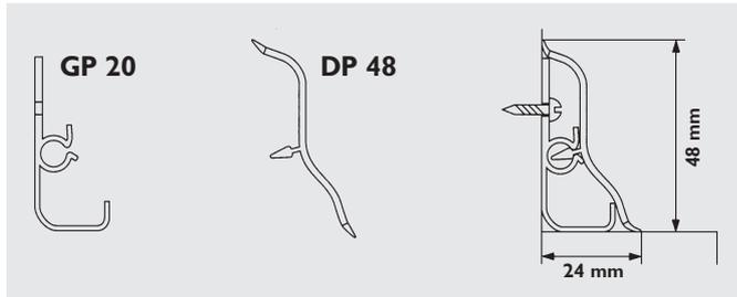
Die Sockelleiste SL 48 besteht aus einem Grundprofil (GP 20) und einem Dekorprofil (DP 48) und den entsprechenden Eckteilen, Endkappen und Verbindern.
